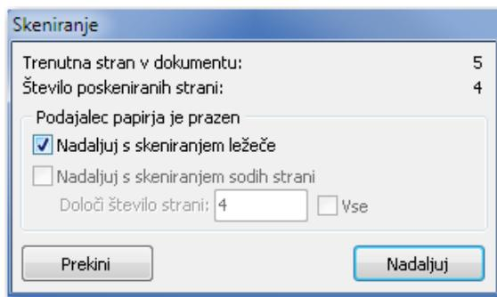
Po končanem skenirjanju vseh listov na podajalcu se skeniranje ustavi z obvestilom v statusnem oknu »Podajalec papirja je prazen«. Skeniranje lahko nadaljujemo tako, da v podajalec vložimo nove dokumente za skeniranje ali pa nov dokument za skeniranje položimo na ploščo za skeniranje (flatbed). Pred tem moramo izbrati možnost »**Nadaljuj s skeniranjem ležeče**«. Proses skeniranja nadaljujemo s klikom na gumb »**Nadaljuj**«. Skeniranje lahko prekinemo s klikom na gumb »**Prekini**«.
