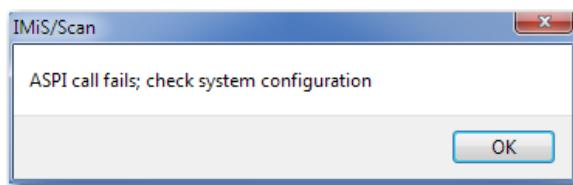
Ob prikazu te napake priporočamo ponoven izbor skenerja in preverjanje statusa skenerja, kot je vključen, ugasnen, priključen na računalnik in podobno.
