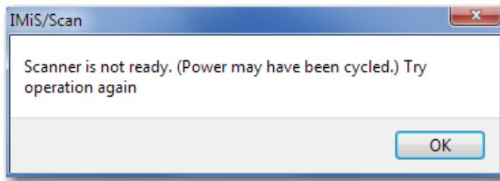
Vzrok: Gonilnik skenerja ni naložen v aplikacijo IMiS®/Scan ali pa ne more vzpostaviti začetne komunikacije s skenerjem.
